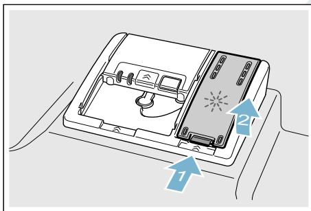
2. Заполнить ополаскиватель до отметки «max.».
